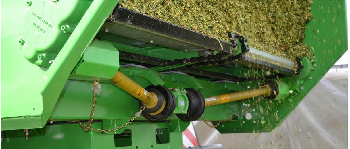
Dorénavant il est possible d'équiper les caisses d'ensilage Silo-SPACE d'un entraînement mécanique du tapis, par cardan et boîtier de transfert.
